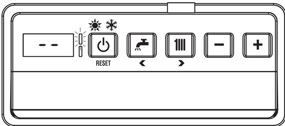
**ATENCIÓN:** para programar las modalidades de funcionamiento, es suficiente tocar las teclas. Un bip indica que la caldera ha tomado el mando. Si se desactiva el PAR 5, el display se queda iluminado siempre.
