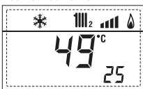
26. Visualizzazione termostato sicurezza con schedino ZONA MIX 2 (ingresso S1) rispettivamente ON e OFF
