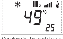
26. Visualización termostato de seguridad con tarjeta ZONA MIX 2 (entrada S1) respectivamente ON y OFF
