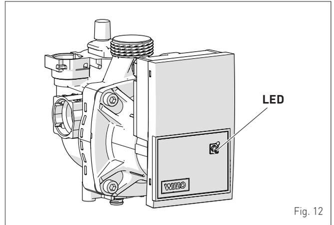
Las calderas destinadas a determinados mercados utilizan la bomba equipada con LED de señalización, que indica:
