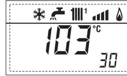
29. Visualización valor de la temperatura de la sonda solar S2 con tarjeta solar INSOL
