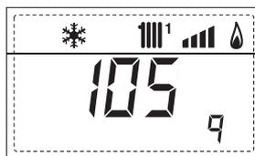
10. Visualización horas de funcionamiento del quemador en h x 100 (ej. 14.000 y 10)
