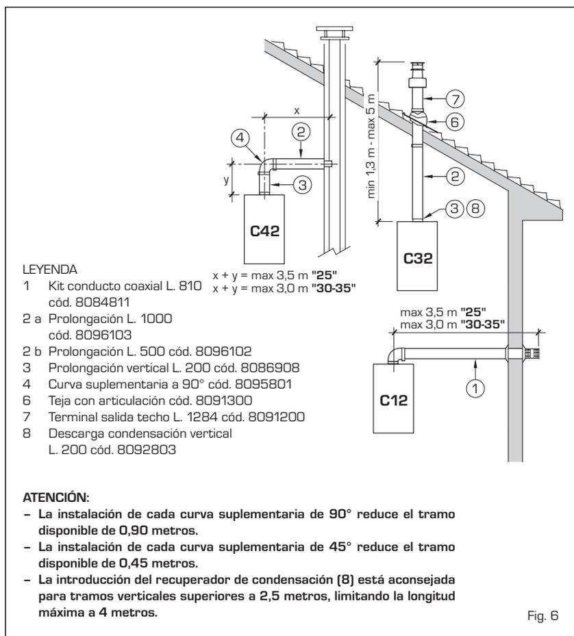
En las tipologías de descarga C12-C42 utilice el diafragma  $\varnothing$  86,0 y  $\varnothing$  87,5 sólo cuando la longitud del conducto coaxial es inferior a 1 m.
