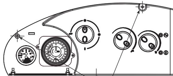
ATENCIÓN: Después de haber sacado los 3 tornillos (9) tirar hacia adelante el panel porque se pueda inclinar hacia abajo.
