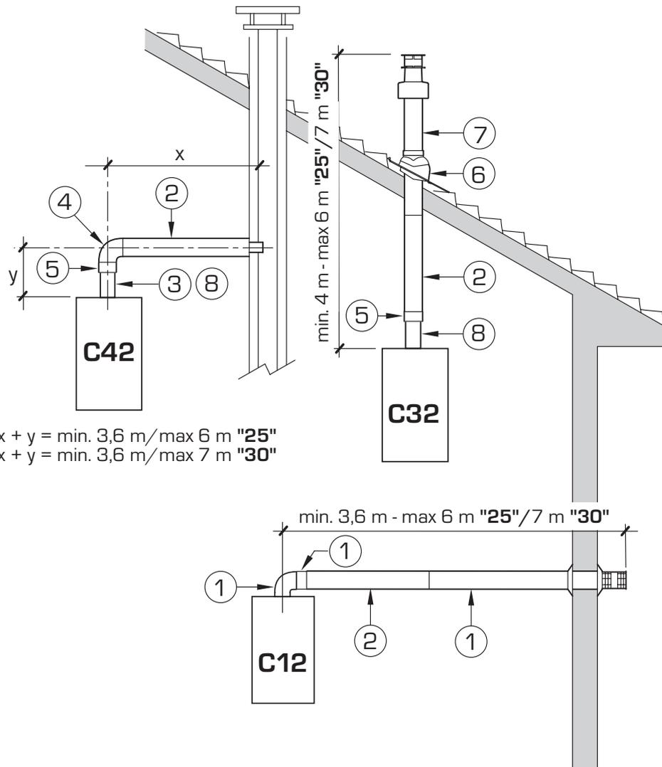
$$x + y = \text{min. } 3,6 \text{ m / max } 6 \text{ m "25"}$$
