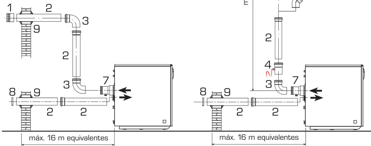
**ATENCIÓN:** La longitud del conducto de aspiración no debe superar los 16 metros equivalentes. La longitud del conducto de descarga no debe superar los 6 metros equivalentes. En las salidas de techo con descarga siempre debe haber una recuperación de la condensación (4); la longitud vertical del conducto sin cambios de dirección no debe superar los 7,6 metros.
