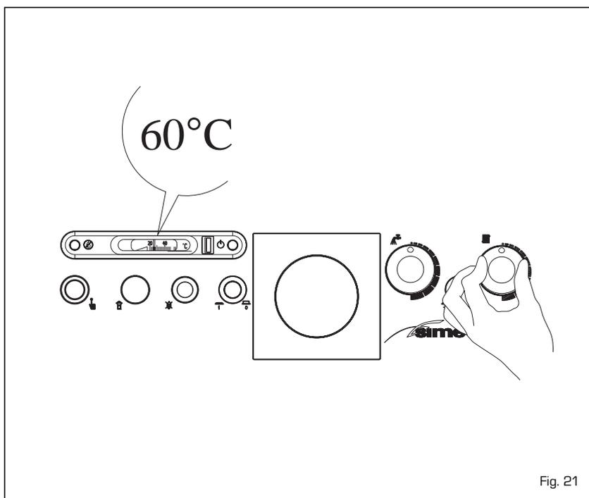
chón de protección y presionar el pulsador que se encuentra debajo (fig. 21). **Si el fenómeno se verifica frecuentemente se debe requerir la intervención del personal técnico autorizado para un control.**
