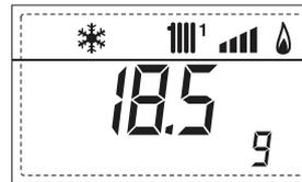
2. Visualización temperatura sonda ida calefacción (SM)
