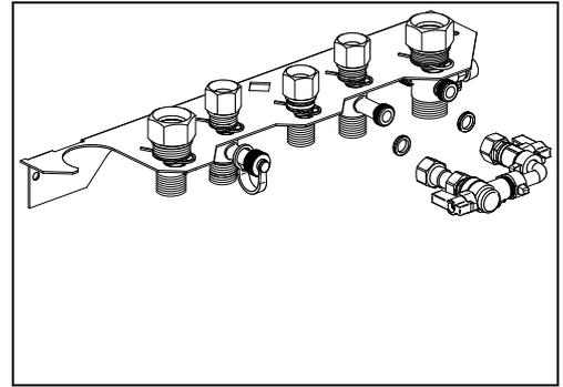
Para la instalación del aparato se utiliza, dependiendo de la situación de conexión, una pletina de sujeción y soporte de montaje o un armazón de conexión superior y soporte de montaje.
