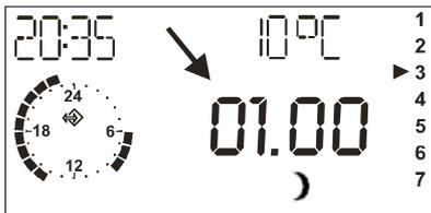
Indicación (aprox. durante 3 s) de la interrupción ajustada de la calefacción => Calentar con la temperatura reducida [ ☀ ]
