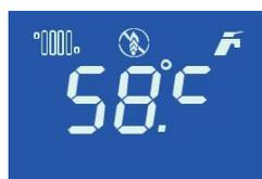
En esta posición, usted puede ajustar la temperatura entre 35 – 60 °C con el botón de ajuste de temperatura del agua caliente doméstica (4) cuyo símbolo se visualizará. Cuando se gira el botón DHW, mientras la luz de la pantalla está encendida, si gira en sentido de las agujas del reloj (derecha) incrementará la temperatura, y usted puede disminuir la temperatura cuando gira el botón en sentido contrario a las agujas del reloj (izquierda).
