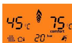
En este caso, la combi se pone inicialmente en posición de radiador, este símbolo parpadea en la esquina inferior izquierda y el símbolo del grifo se ve en la esquina inferior derecha. Un manómetro digital que indica la presión de la instalación se encuentra en la sección central inferior de la pantalla y también la temperatura existente de la instalación del radiador se muestra al mismo tiempo y la pantalla se apagará.
