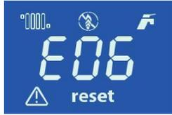
Un error de utilización de muestra; cuando los códigos de fallo E81 o E06 se muestran en la pantalla del dispositivo, ha pasado a fallo ya que no se produjo ningún arranque en su dispositivo. En ese caso, se puede cerrar cualquiera de las válvulas de la tubería de gas conectadas a la combi, se reanuda la combi cuando se abra la válvula cerrada y se presione el botón RESET. Si la combi no se inicia con el restablecimiento, consulte nuestro Servicio Autorizado.
