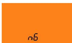
Cuando la combi se inicia por primera vez, la pantalla muestra las letras nG y entonces un número (por ejemplo 24) indicando la potencia en kW del dispositivo.
