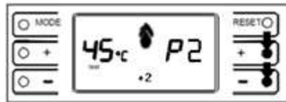
11. Una vez ajustada la potencia máxima, presione los botones "MODE" Y "RESET", hasta que se complete el círculo de confirmación en el DISPLAY y suelte los botones para salir del menú de autocalibración.
