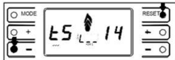
8. Esperar hasta que se complete el círculo de confirmación en la pantalla. Una vez acabado, volverás a la pantalla principal.
