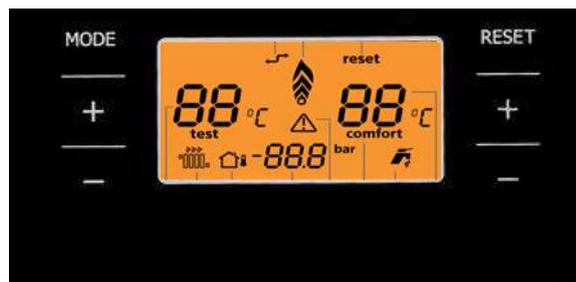
Si visualiza los códigos de fallo E81 o E06 en la pantalla del dispositivo es que no pudo producirse el arranque en su dispositivo. Debe verificar que la llave de gas de instalación esté abierta.
