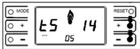
6. Pulse el botón **"RESET"** para guardar el valor. Esperar a que el círculo se complete.
