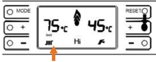
6. Cuando se completen las mediciones del técnico, pulse simultáneamente los botones “MODE” y “RESET” para salir.
